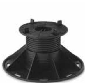
PP level FIX è una linea di **supporti regolabili a testa fissa** per pavimenti sopraelevati da esterno autoportanti. Disponibili per altezze da 25 a 280 mm, i supporti PP level FIX sono regolabili in altezza tramite chiave di regolazione dall'alto e sono dotati di testa con alette per fughe da 4 mm. Ideali per pavimentazioni su superfici piane o nei casi in cui il pavimento debba essere parallelo alla superficie su cui poggia il supporto.
