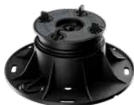
PP level MAXI FIX è una linea di **supporti regolabili a testa fissa** per pavimenti sopraelevati da esterno autoportanti. Disponibili per altezze da 25 a 462 mm, i supporti PP level MAXI FIX sono regolabili in altezza tramite chiave di regolazione dall'alto e sono dotati di testa con alette per fughe da 4 mm. Ideali per pavimentazioni su superfici piane o nei casi in cui il pavimento debba essere parallelo alla superficie su cui poggia il supporto.
