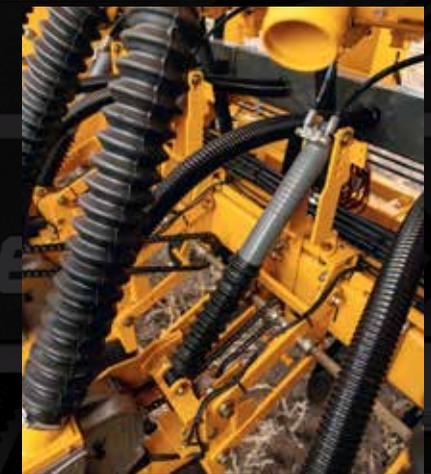
Actuador de doble cámara, una neumática de presión regulable que imprime una fuerza constante sobre el cuerpo de siembra. A diferencia de sistemas similares, el TWIN FORCE cuenta con otra cámara hidráulica que otorga amortiguación controlando y estabilizando oscilaciones del cuerpo de siembra, esto permite sembrar en terrenos desparejos, un 20% más rápido en cualquier condición (\*).
